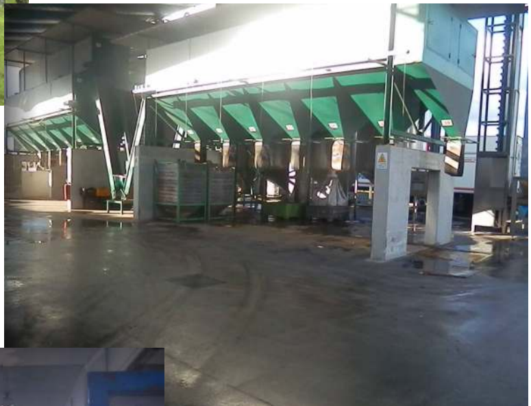
Impianto di calibrazione e pesatura di castagne fresche
